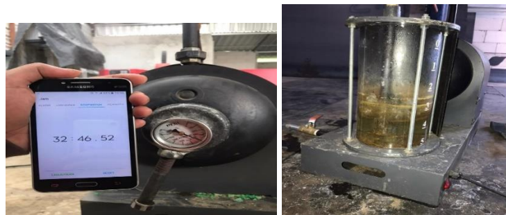
Gambar 3. Tabung reaktor dan kondensat pada temperatur 200°C
