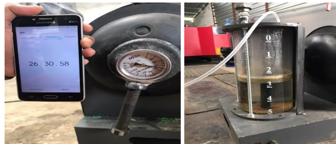
Gambar 2. Tabung reaktor dan kondensat air pada temperatur 100°C
