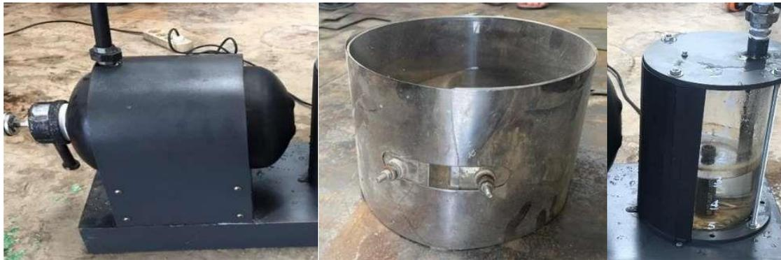
Gambar 7. Tabung reaktor, *heater*, tabung kondensat
