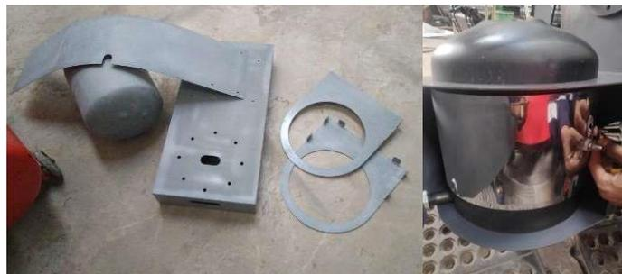
Gambar 3. Pemotongan bahan dan pemasangan *heater band*
