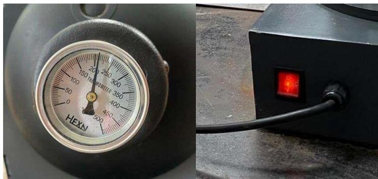
Gambar 6. Termometer analog dan saklar
