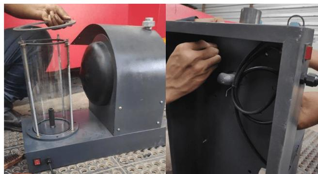
Gambar 4. Penggabungan tabung reaktor, tabung kondensat, dan pemasangan kabel
