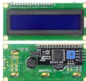
Gambar 2. LCD 16 x 2 dengan modul I2C
