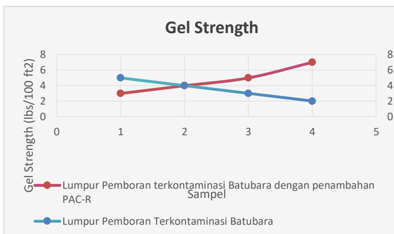
Gambar 5. Hasil Pengujian Gel Strength pada lumpur pemboran
