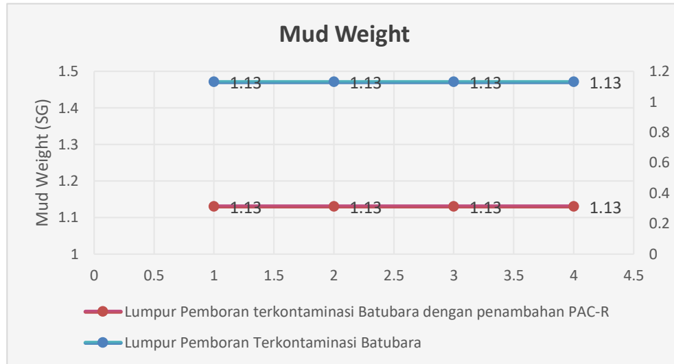
Gambar 2. Hasil Pengujian Mud Weight pada lumpur pemboran
