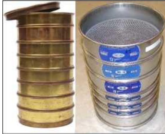
Gambar 2. Alat yang digunakan untuk pengayakan sampel yang dinamakan dengan mesh
